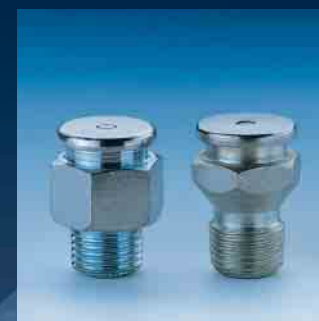
Плоские прессмасленки M22 с клапаном прямые (180°) Диаметр головки 22 мм. Оснащены специальным клапаном, герметично уплотняющим место для подачи смазки и препятствующим обратному выходу смазки. Выдерживают внутреннее давление до 1.000 бар.
